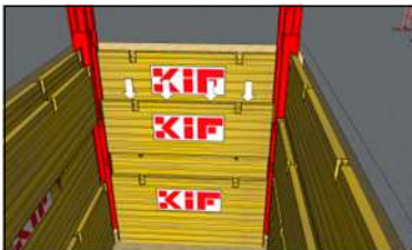
17. Puis des panneaux rehausse seront enclenchés sur les panneaux de base en partie basse de la fouille (dans le rail intérieur).
