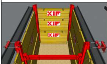
23. Mise en place d'une ceinture haute par une lieme en poutrelles de section conséquente.
